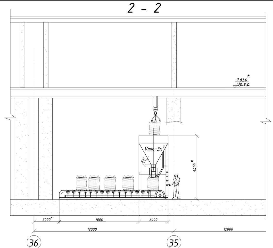
Станция затаривания СЗ-500 10/1Л с ленточным транспортером длиной 2м и накопительным транспортером длиной ЛК-Ш-П-Г-1200-7000-273-Ф-А-603-4-13 длиной 7м (полуавтомат). Предназначена для фасовки сыпучих продуктов фракции от 500 до 3500кг/м. (МП Строймеханика). Установка должна комплектоваться.
